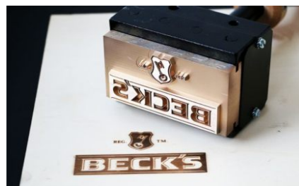
Держатель пуансонов высотой 2-5 мм (от 4 до 20 шт. в держателе)
